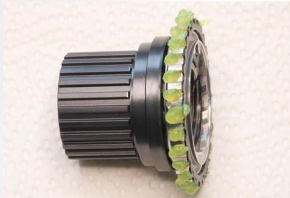
Lubrica la zona dentada del núcleo de la rueda libre con grasa de alta calidad (Y041 10000). En el dibujo puede ver la cantidad correcta de grasa a aplicar
