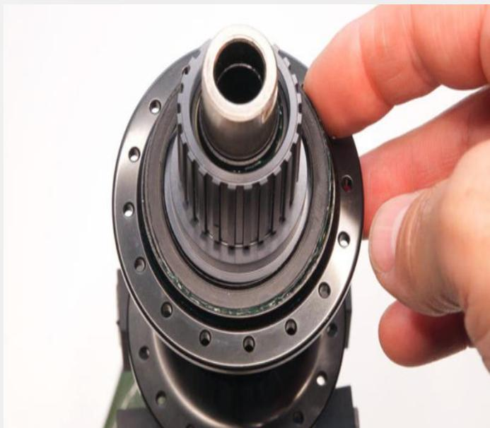
Coloque cuidadosamente el anillo obturador en la carcasa del buje. No utilice un anillo obturador deformado.
