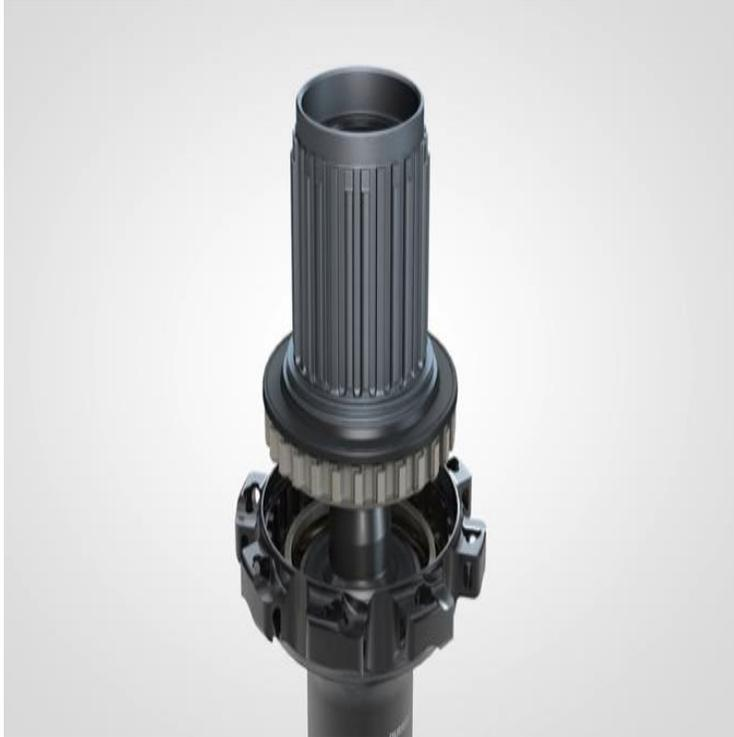
Extraiga el núcleo con el anillo obturador y el espaciador
