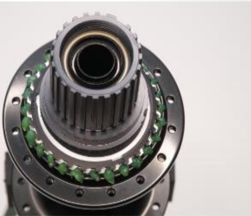
Instale el núcleo de la rueda libre. Asegúrese de que la parte dentada de la carcasa queda correctamente alineada con la parte dentada del núcleo de la rueda libre. Distribuya grasa de manera uniforme por encima del separador
