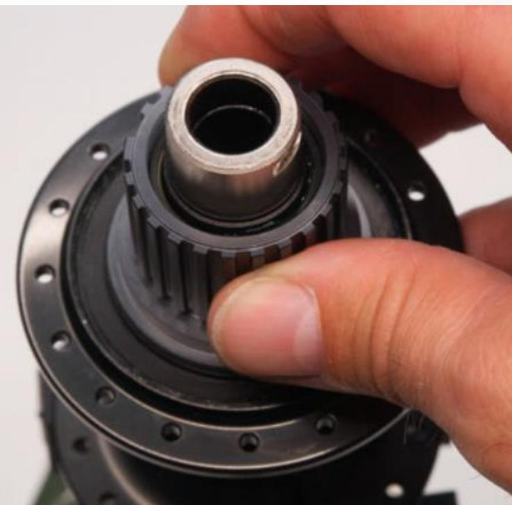
Confirme la posición correcta haciendo girar el cuerpo de la rueda libre. Debería enganchar cuando se mueva hacia adelante y desenganchar cuando se gira hacia atrás.
