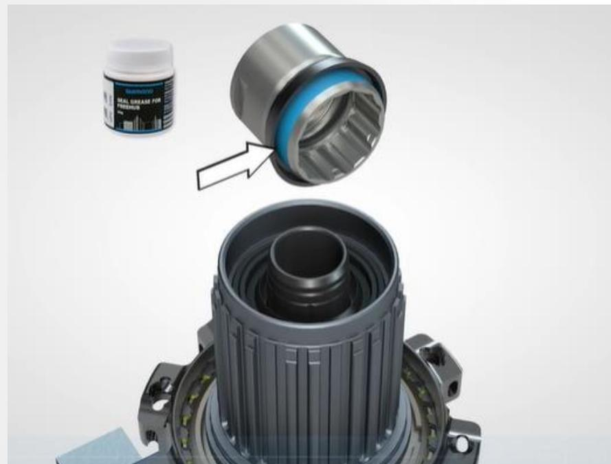
Aplicamos grasa de sellado en esta parte de la tapa, colocamos la tapa alineando la protrusión de la tapa con la ranura del eje y empujamos.
