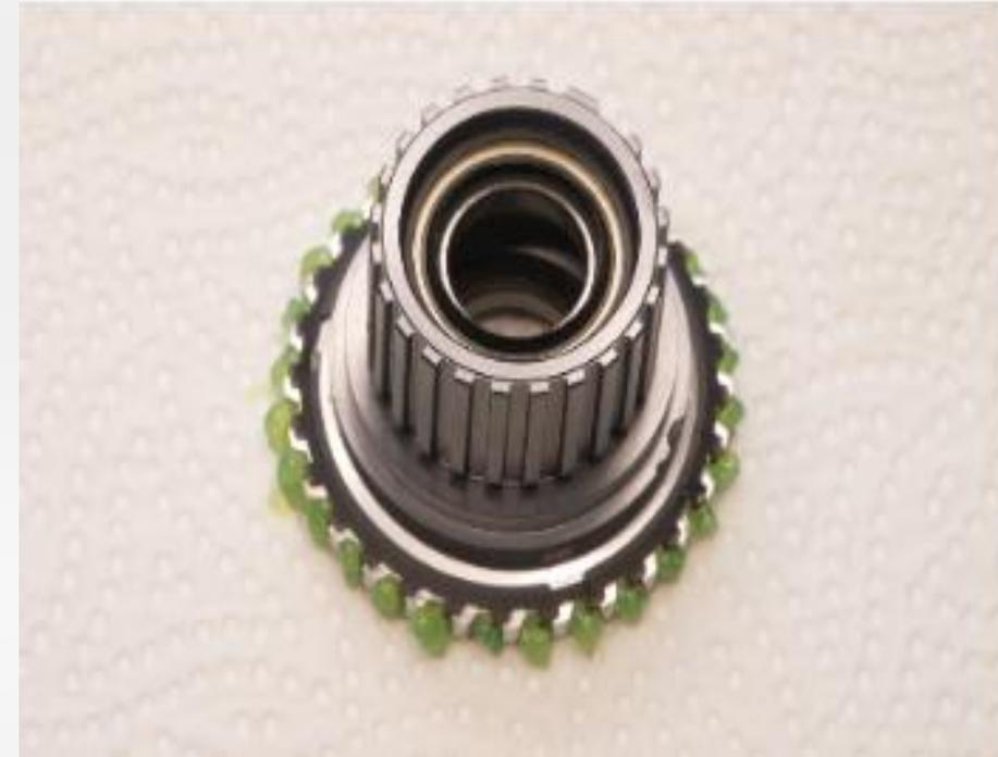
Instale el separador y asegúrese de que los salientes quedan colocados como en el dibujo
